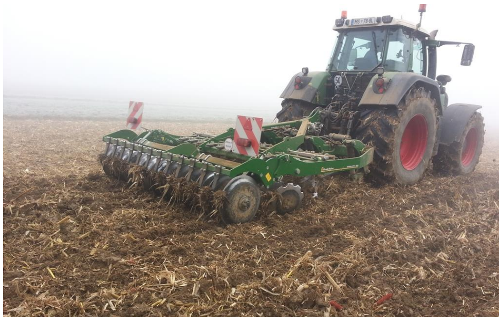
Slika39: Gojenje koruznih strnišč po žetvi s krožnimi branami.
