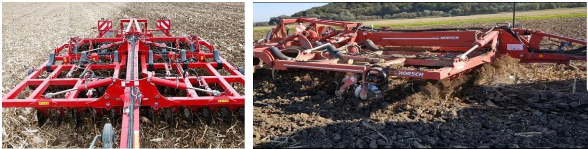
Slika30: Stroji, ki se uporabljajo za gojenje tal brez oranja na kmetiji ŽIPO Lenart.
