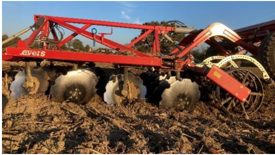
Slika33: Mehanizacija za gojenje tal se uporablja na Žnidaričevi kmetiji. Levo: krožne brane za gojenje tal. Desno: Glavnik Har-row orodje za nadzor plevela v zgodnjih fazah rasti žit.
