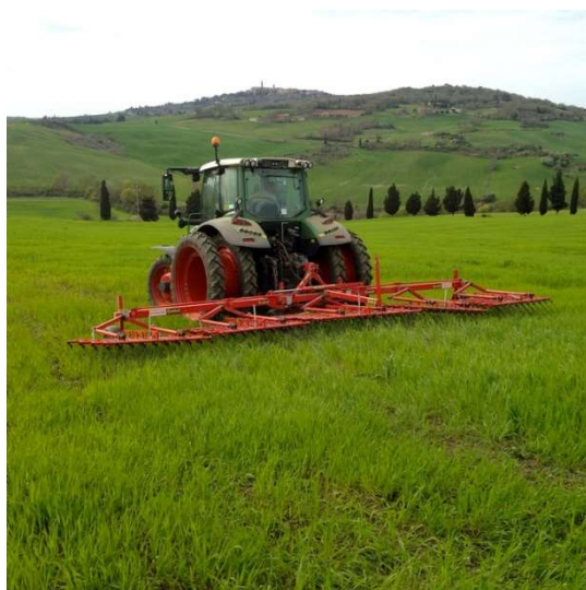
Fig.1 Trattore con erpice a denti flessibili per la rimozione delle erbacce nel frumento duro.
